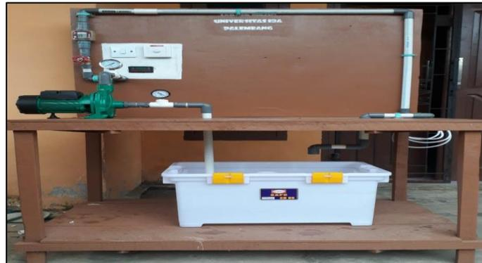
Gambar 3. Rangkaian Alat Uji
